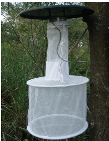
ภาพที่ 12 กักตักยุงแบบใช้แสงไฟ (CDC Light Trap)
